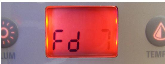
L'écran affichera Fdxx, avec le « xx » représentant la durée du cycle de filtration en heures. Servez-vous des touches de flèche pour ajuster la durée. Appuyez sur la touche de lumière pour passer au prochain paramètre, soit la fréquence de filtration (FF).
