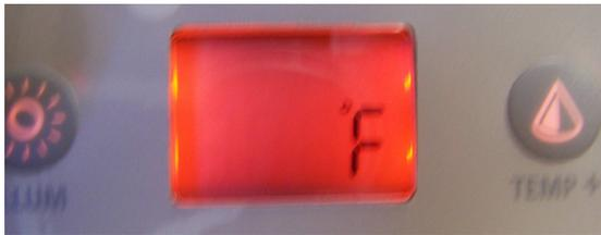
La température de l'eau peut être affichée en degrés Fahrenheit ( $^{\circ}\text{F}$ ) ou Celsius ( $^{\circ}\text{C}$ ). L'écran affichera soit  $^{\circ}\text{F}$  ou  $^{\circ}\text{C}$ . Servez-vous des touches de flèche pour modifier le réglage. Appuyez sur la touche de lumière pour enregistrer tous les paramètres.
